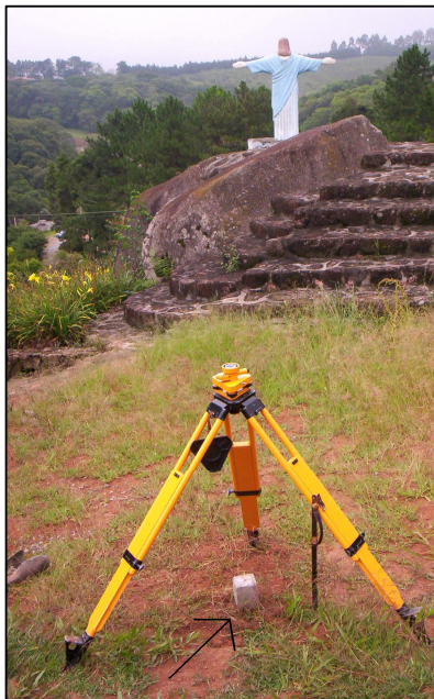
Figura 18 – Marco geodésico implantado como base em Piedade/SP
