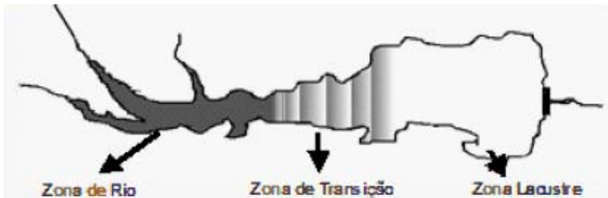
Figura 1: Compartimentalização longitudinal de um reservatório idealizado. Modificado de Thornton et al. (1990).
