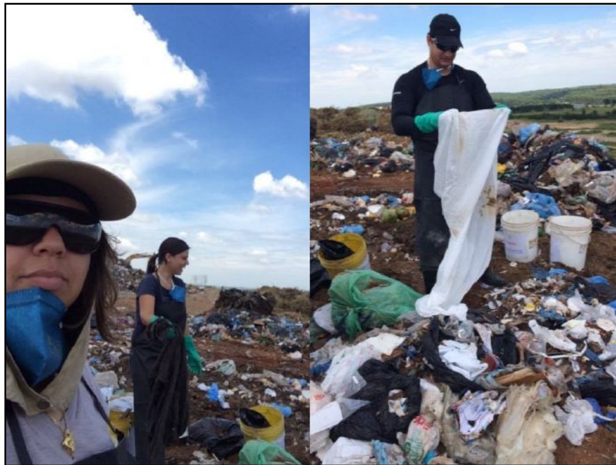
Figura 4. 12 - Caracterização gravimétrica do RSU no Aterro Delta A
